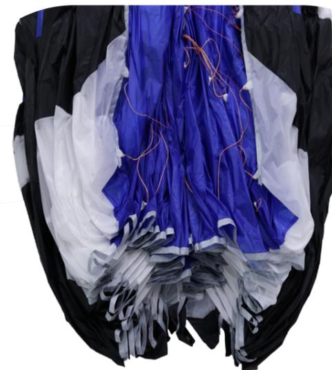
Étape 3 : Procédez de la même manière avec les profils du bord d'attaque. Placez les renforts du haut et du bas dans le bon sens, ne fermez pas les ouvertures des cellules et poussez le tissu vers l'extérieur.
