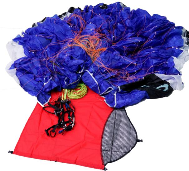
Étape 1 : Ouvrez le sac d'origami et tirez partiellement à l'intérieur. L'extérieur ressemblera à un chou. De cette façon, tu évites que la voile ne traîne sur le sol pendant le pliage.
