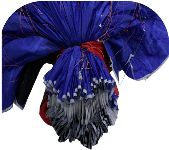
Étape 3 : Procédez de la même manière avec les profils du bord d'attaque. Placez les renforts du haut et du bas dans le bon sens, ne fermez pas les ouvertures des cellules et poussez le tissu vers l'extérieur.
